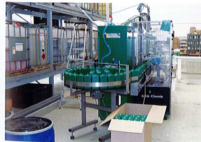
In der Abfüllanlage von ILKA-Chemie werden 3000 Flaschen pro Stunde abgefüllt.
