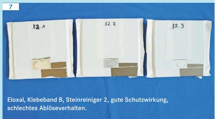
Eloxal, Klebeband B, Steinreiniger 2, gute Schutzwirkung, schlechtes Ablöseverhalten.
